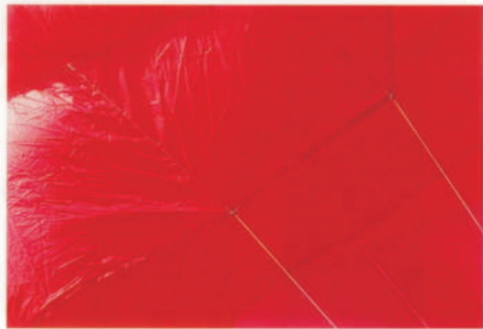
Die Waageschnur ist aussen nur durch die Naht über die Schnur ersichtlich
